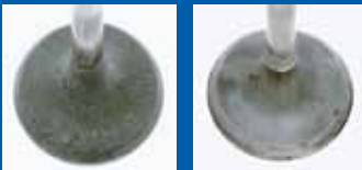
Magnification of Injector Deposits Clogging Fuel Spray Pattern / Agrandissement du mode de vaporisation pour les dépôts d'injecteur et encrassement du carburant
